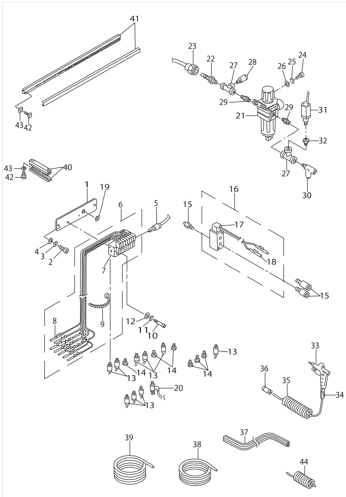
**SOLENOID VALVE & REGULATOR COMPONENTS**
