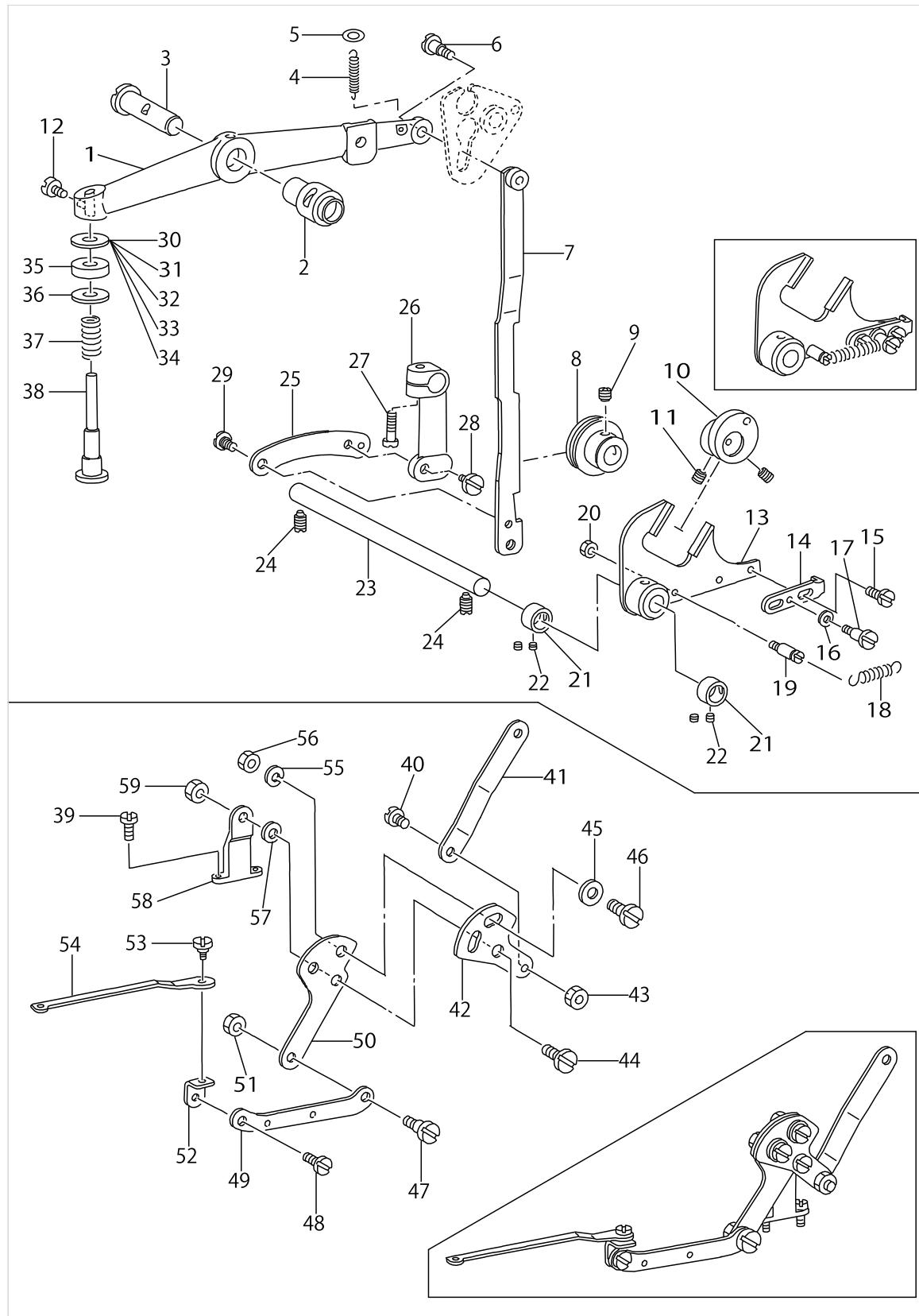
BUTTON CLAMP LIFTER & THREAD TRIMMER COMPONENTS
