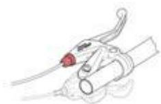
2. Перейдите к проверке тормозов. Сожмите рукоятки тормозной системы — торможение начнется, когда рычаг прошел около половины расстояния, а рукоятка, при максимальном приложенном
