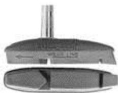
**1. Тормозные колодки.** Постоянное стачивание тормозных колодок, в какой-то мере, просто необходимо для долгой работы велосипеда. При разработке материалов для рабочей поверхности колодок, производитель пытается найти компромиссный вариант между долговечностью и жесткостью, ведь слишком твердая абразивная поверхность колодки, начинает стачивать обод колеса, который, как правило, гораздо дороже пары резиновых колодок.
